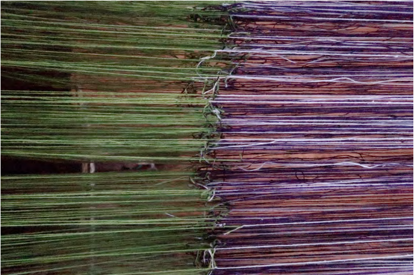
nouage d'une chaîne pour un changement de fil
