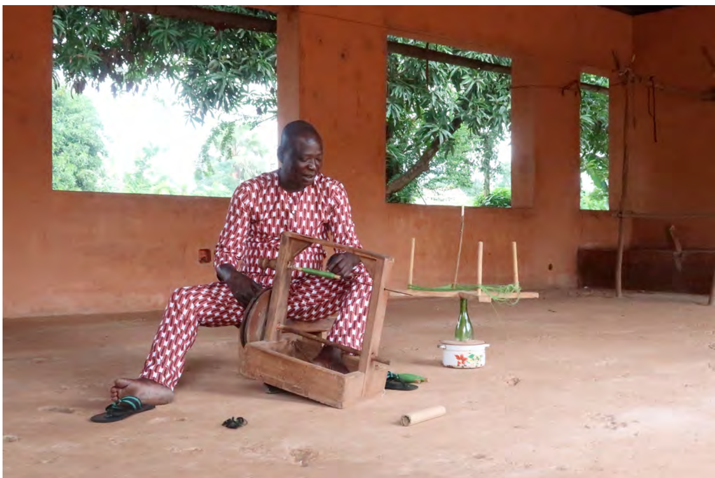
conditionnement d'une canette à partir d'un écheveau
