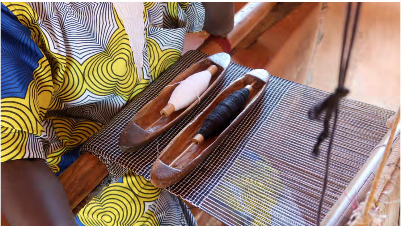
fil de trame, enroulé sur des canettes, chacune insérée dans une navette
